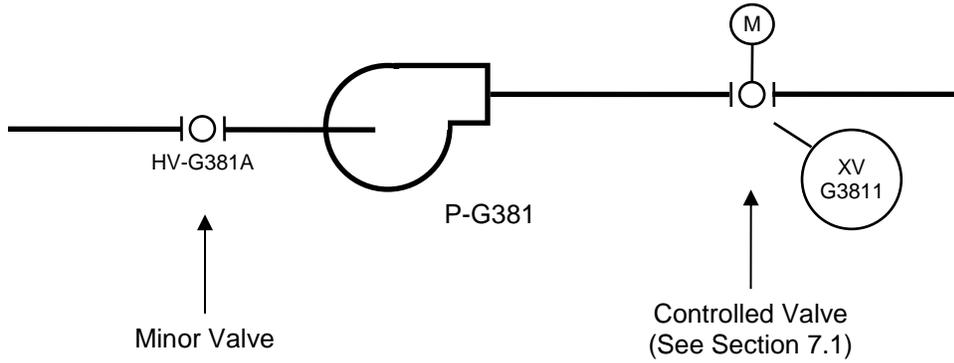
**Figure 5-1 : Valve Identification**
